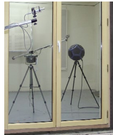
Installation des microphones.
